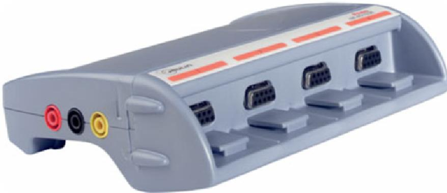
**A L'avant :** Quatre emplacements pour mettre des capteurs, numérotés de 1 à 4
